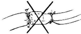
Figura 16. NO atar las suturas demasiado apretadas y NO atar una sutura al cuerpo del cable
