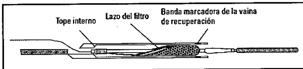
Figura 2. Posición del filtro recuperado dentro de la vaina de recuperación EZ
