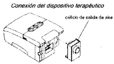
**Extracción del conector del orificio de salida de aire del dispositivo terapéutico**
