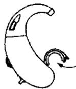
Para poner su audífono a funcionar, inserte primeramente una pila en el respectivo compartimiento (5). Abra cuidadosamente la tapa del compartimiento de pila poniendo la uña en la ranura provista y jalando hacia afuera.
