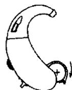
A continuación inserte la pila en el compartimiento correspondiente. Coloque la pila de modo que el signo (+) corresponda al signo (+) del compartimiento de pila. Ahora encienda el aparato utilizando el conmutador (4).
