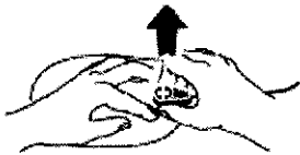
Figura 11 Desconexión del cable de desfibrilación de los electrodos FAST-PATCH
