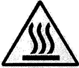
A fin de generar y mantener un campo magnético suficiente, se carga el electroimán con una corriente eléctrica elevada, que a su vez genera una cantidad de calor significativa. Por consiguiente, la carcasa del imán puede estar muy caliente durante y también después del funcionamiento. Evite tocarla y no cubra las salidas de ventilación del sistema.
