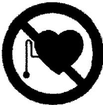
Prohibida la presencia de marcapasos junto al instrumento. Toda persona que lleve un marcapasos debe mantener una distancia de seguridad de como mínimo dos (2) metros respecto del instrumento siempre que esté encendido.
