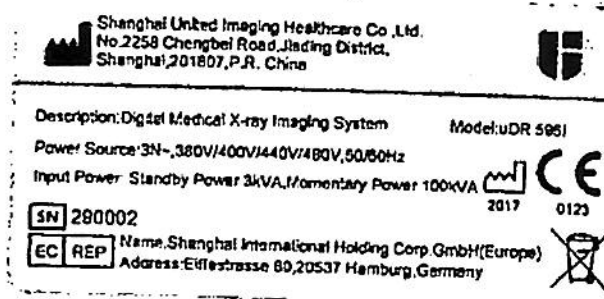
Fig. 3.1.2 - Rótulo con Datos del Fabricante del uDR 596i
