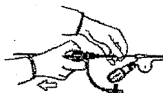
Figura 27. Retirada de la válvula
