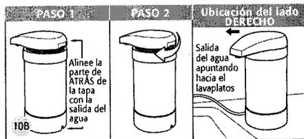
10. Determine en qué lado del lavaplatos desea su Sistema: Para ubicar el Sistema en el lado IZQUIERDO de su lavaplatos: Desenrosque la Tapa del Armazón del Filtro, y posicóñela en la misma dirección del armazón (Figura 10A, Paso 1). Una vez ubicada, gire la tapa en el armazón en la dirección de las agujas del reloj, hasta que quede bien ajustada (Figura 10A, Paso 2).
