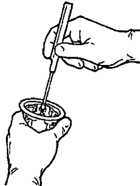
Figura 6. Inserte el colocador en el portaválvulas.
