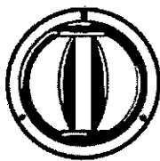
Figura 12a. Tres marcadores de sutura en el anillo de sutura aórtico (sólo poliéster).
