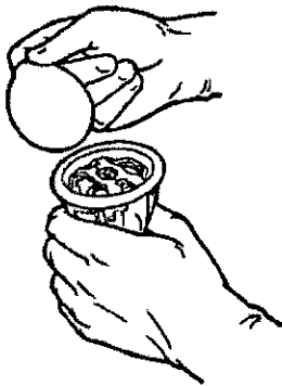
Figura 5. Retire por completo el precinto de la bandeja interior.
