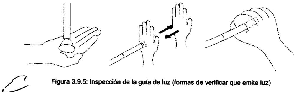
Figura 3.9.5: Inspección de la guía de luz (formas de verificar que emite luz)
