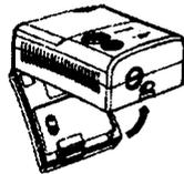
2. Para instalar la batería, enfile el extremo posterior del compresor Innospire Mini con el extremo posterior de la batería recargable de ion litio.
