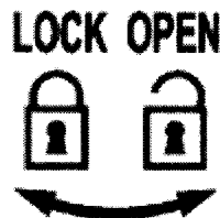
Figura 4-6 Posición de bloque y desbloqueo de los conectores de sonda
