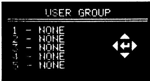
Con esta función identificamos a los usuarios que tiene acceso a la operación de la centrifuga, esta identifica hasta 5 usuarios, cada usuario se identifica con un nombre que puede tener 10 caracteres y un código de identificación de hasta 16 caracteres. Utilizando o no la lectora de código de barra.
