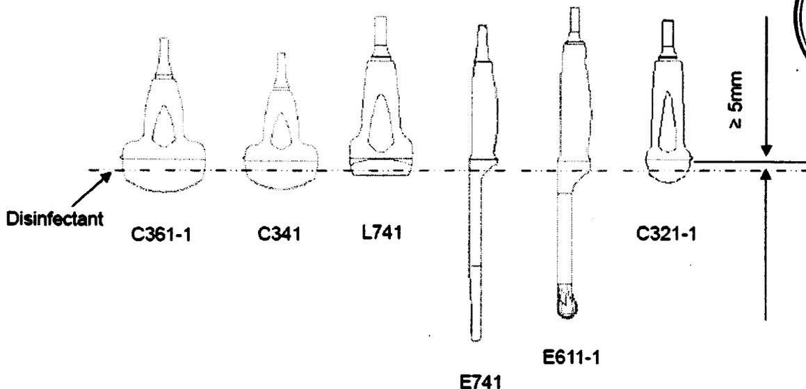
Fig 3.7.1 – Modo correcto para el procedimiento de desinfección del transductor
