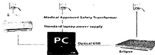
Fig.4: Ordenador conectado a la red eléctrica y, a su vez, conectado a la plataforma Eclipse mediante un cable USB óptico
