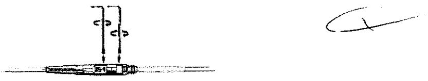
Figura 2. Gire el tornillo de fijación en el orificio roscado en el receptáculo del alargador.
