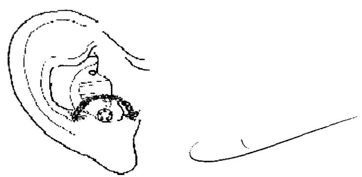
El interruptor de encendido/apagado puede estar incluido en este control de volumen. La rueda de control de volumen se gira para seleccionar la posición de audición deseada (más fuerte o más suave). Antes de colocar el instrumento auditivo en su oído asegúrese que el volumen está colocado al mínimo.
