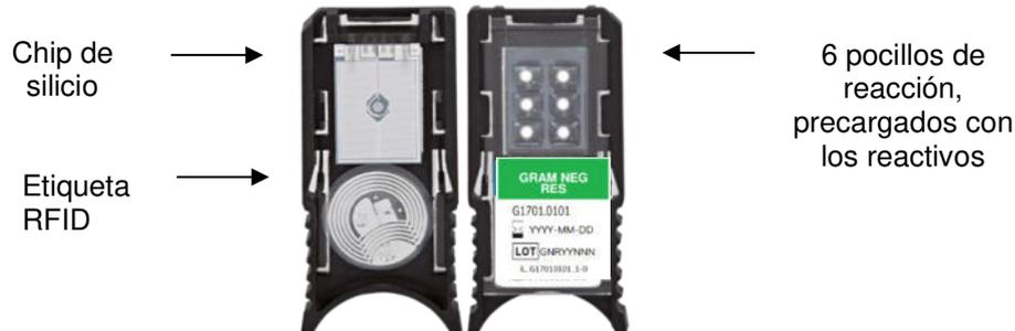
Figura 1.5 Ejemplo de un cartucho MOLECULAR MOUSE IVD, vista posterior y vista frontal. [FACSIMILE]
