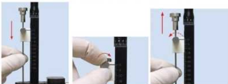
Figura 7. Instalación de la sonda de verificación.
