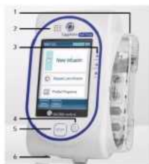
Figura 2.1. Componentes de hardware (Multiterapia)
