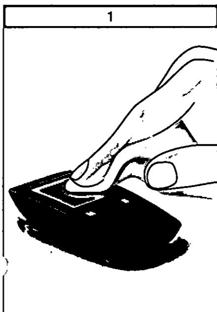
Limpie la carcasa del medidor de glucemia con un paño humedecido ligeramente con isopropanol al 70 %.
