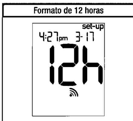
Al finalizar los ajustes, el medidor muestra los ajustes actuales.
