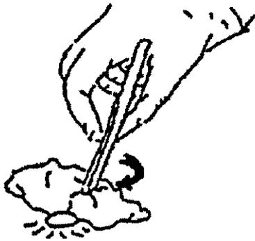
Use solamente agujas Huber non-coring (sin efecto sacabocado) tales como las agujas Huber Jetcan™ para puncionar la membrana del portable.
