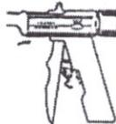
5. Coloque el cartucho nuevo de la misma manera e inserte suavemente en el porta cartucho del dispositivo. El nuevo cartucho se ajustará en la posición correcta cuando hay un sonido de clic.
