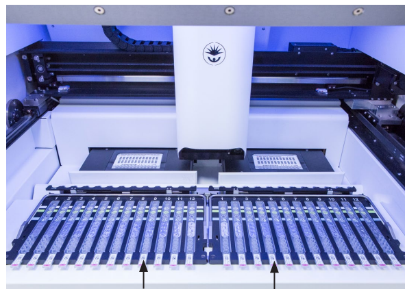
Lado A Lado B Figura 3: Carga de gradillas en el sistema BD MAX™
