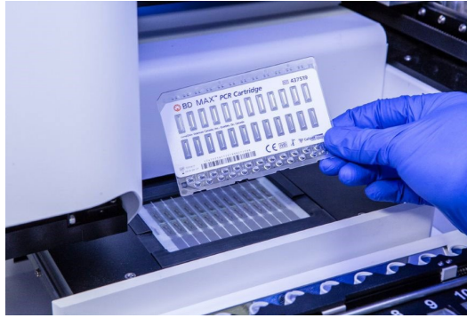
Figura 2: Carga de las tarjetas de PCR BD
