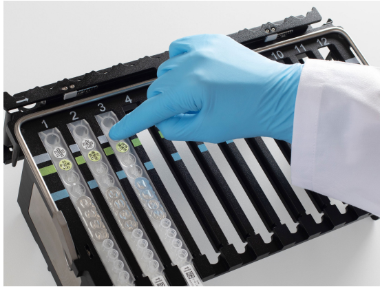
Figura 1: Colocación de tubos de mezcla maestra y de extracción BD CTGCTV2 en las tiras de reactivos individuales
