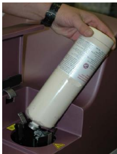
Figura 6.11: Sustitución del frasco de refrigerante
