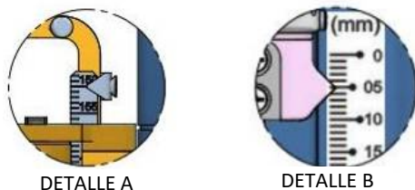
Figura 4: Eje Z (Detalle A) y distancia hasta el objetivo (Detalle B)
