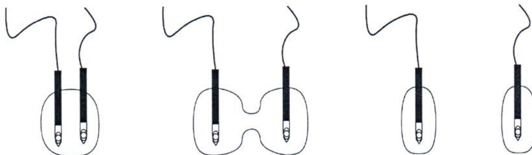
Figura 26. Ejemplo de cómo afecta el distanciamiento a la forma de la lesión
