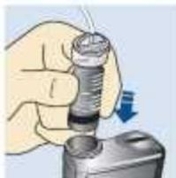
3. Gire el conector del tubo hacia la derecha hasta que el conector se bloquee. El conector del tubo debería estar alineado horizontalmente con la parte superior de la bomba.
