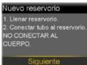
El reservorio ahora se puede llenar y conectar al conector del tubo del equipo de infusión. Siga los pasos de la sección siguiente para completar estas acciones antes de seleccionar Siguiete en la pantalla de la bomba.
