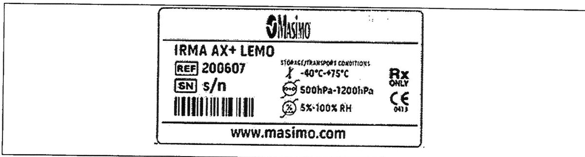
Figura 3: Etiquetas provistas por el Fabricante para el analizador de gases de flujo principal IRMA modelos: IRMA AX+, IRMA AX+ Bluepoint, IRMA AX+ LEMO, N° de referencia, N° de serie y condiciones de almacenamiento y transporte.
