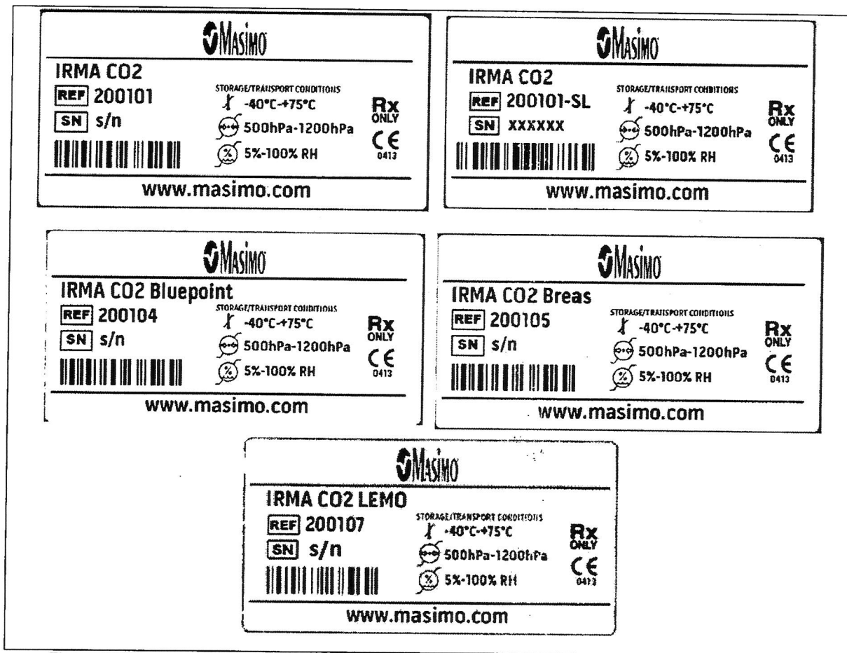
Figura 2: Etiquetas provistas por el Fabricante para el analizador de gases de flujo principal IRMA modelos: IRMA CO2, IRMA CO2 Spacelabs, IRMA CO2 Bluepoint, IRMA CO2 Breas, IRMA CO2 LEMO, N° de referencia, N° de serie y condiciones de almacenamiento y transporte.
