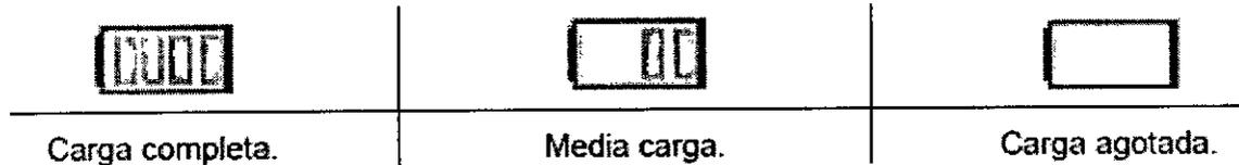
Las baterías se recargan únicamente mientras el equipo se encuentra conectado al suministro de energía principal. Durante el proceso de carga el icono que se ilustra es dinámico, va cambiando el nivel de carga continuamente. Los iconos ilustrados arriba solo pueden observarse cuando el monitor está funcionando con las baterías. Si el monitor se encuentra conectado al suministro principal y la batería está completamente cargada, no se observa ningún icono en la pantalla.
