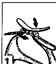
1 Coloque los extremos estrechos del retenedor de tubo alrededor de la hebilla superior del amés.
