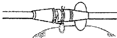
Figura 10. Manguito ranurado de fijación de triple surco afianzado al cable y a la fascia mediante dos surcos
