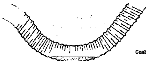
Exceso de condensación en el tubo de suministro
