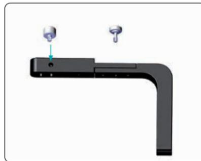
Figura 81: Fijación de la guía de broca.
