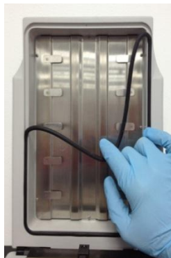
Retirar la junta de la cubierta
