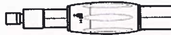
Figura 11. Mango de liberación del mecanismo de captura de punta en la posición de bloqueo
