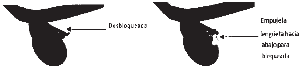
Figura 3.9 Ruedas desbloqueadas (izquierda) | Ruedas bloqueadas (derecha)
