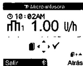
En el modo de control a distancia, el icono de la tecnología inalámbrica *Bluetooth* aparece en la pantalla del medidor y en la pantalla de la micro-infusora.
