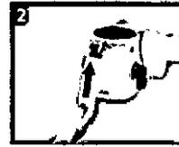
Introduzca el forro de la empuñadura hasta que se encaje.
