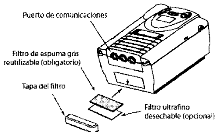
Figura 5-1 Instalación de los filtros de aire
