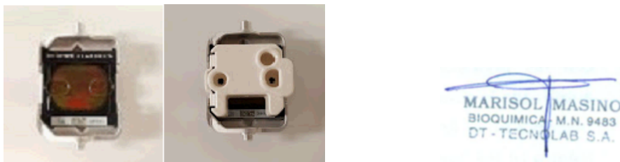
Figura 8. Chip Ion Torrent en el cestillo del rotor
