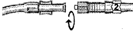
Fig 7. Conexión de un Tubo del calentador n.º 2 al tubo inferior del Cassette del calentador
