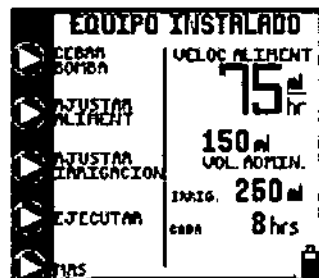
Figura 7B. Menú inicial del modo de alimentación continua con un equipo de irrigación y alimentación.
