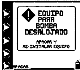
Figura 31. Pantalla de error de equipo para bomba desalojado.
