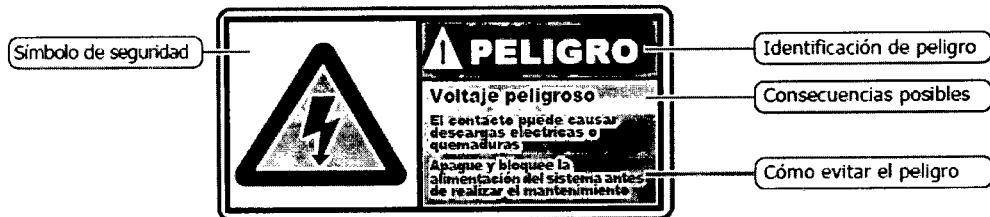
Figura 3-1: Componentes de las etiquetas de seguridad
