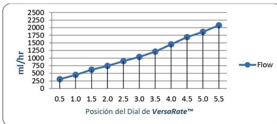
Gráfico de Tasa de Flujo VersaRate ® (con 0,9% Solución Salina y 15 PSI de presión)
