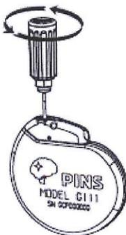
Figura 7. Retirar el tornillo de fijación
