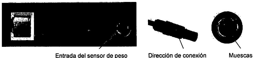
Fig. 3.4.1 G 2): Conexión del sensor de peso de la balanza
