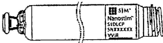
Figura 1. Marcapasos sin cables (LP) Nanostim
