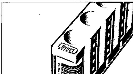
La ID de rack se muestra en la parte superior del rack.
